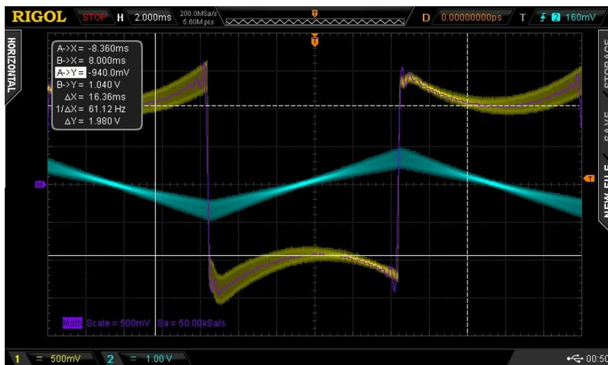
**Рис. 8. Пример экспериментальных измерений (желтый график – сигнал на эталонном резисторе, фиолетовый график – отфильтрованный сигнал на эталонном резисторе, голубой график – сигнал с демодулятора акселерометра)**
