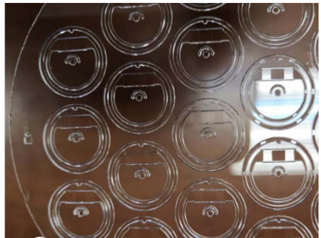
Рис. 7. Маятники, изготовленные групповой MEMS технологией
