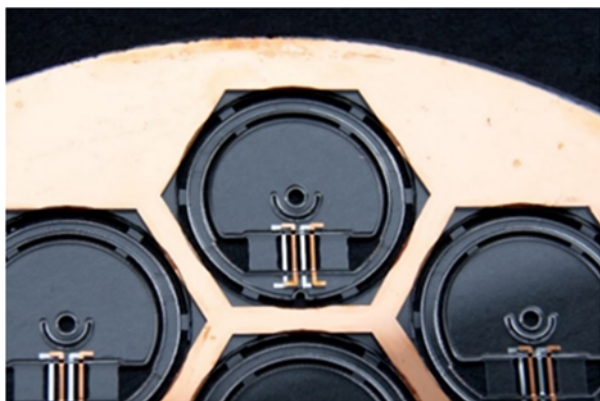
Рис.11. Эскизный вариант кварцевого маятника со свободновисящими токоподводами, выполненный по технологии MEMS
