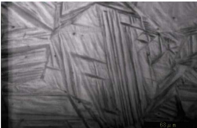
Рис. 14б. Мартенситная структура
